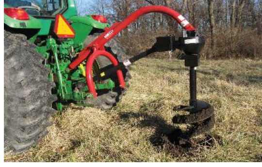
حفار يعمل بقوة الجرار
