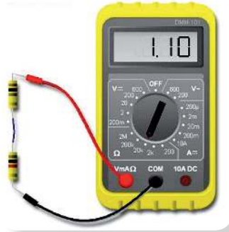
الشكل (٤) قياس المقاومة بجهاز المالتيميتر
